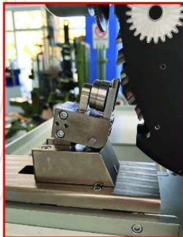
La macchina effettua in automatico la regolazione dell'inclinazione del sistema di appoggio, sulla base di quanto impostato sul touchscreen.
